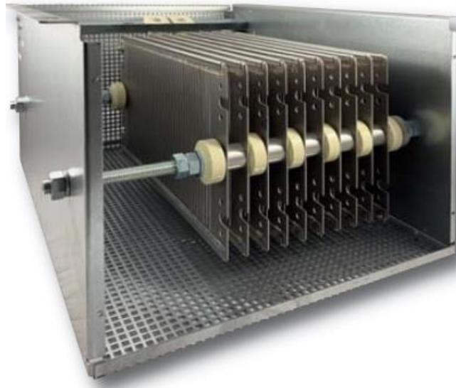
Neben der klassischen Anwendung als Heizung oder Chopperwiderstand kann die Bauform auch für Strombegrenzung, Entladung, als Crowbar, FRT, LVRT, Not-Aus, Belastungs-, Anlass-, Dauervor-, Brems- oder Filterwiderstand genutzt werden.
